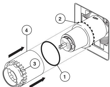
Faites glisser le joint torique (1) sur la cartouche et l'écrou à portée sphérique (2). Le joint sert de pièce d'espacement et il stabilise le manchon; il doit se trouver derrière l'écrou à portée sphérique.
