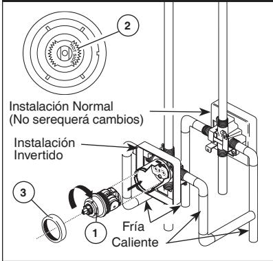
En las instalaciones dorso con dorso (el agua caliente en la derecha y la fría en la izquierda): Gire el cartucho (1) de manera que las palabras "HOT SIDE" (LADO CALIENTE) (2) aparezcan en la derecha. Instale el cartucho asegurando que la guía quede totalmente encajada en la muesca de la pieza de latón. Deslice la tuerca tapa (3) sobre el cartucho y enrosque en el cuerpo de la válvula. Apriete a mano bien.
