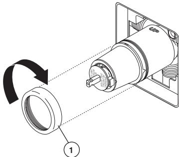
Faites glisser l'écrou à portée sphérique (1) sur la cartouche et vissez-le sur le corps. Serrez à la main fermement.
