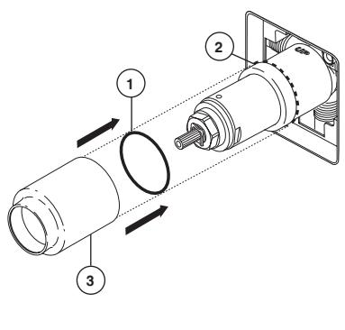
Deslice el aro O (1) sobre el cartucho y la tuerca tapa (2). El aro O, el cual funciona como un separador para estabilizar la manga, debe quedar apoyado en la tuerca tapa. Deslice la manga (3) sobre el cartucho, el cuerpo de la pieza y el aro O.
