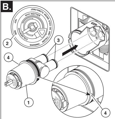
Gire el cartucho (1) de manera que las palabras 'hot side' (lado caliente) (2) aparezcan a la izquierda. Introduzca el cartucho en la válvula como se muestra. Asegúrese que los tubos del cartucho y los aros-O (3) estén apropiadamente sentados en los agujeros en la base del cuerpo de la válvula. Asegúrese que la parte dentada en el cuerpo de la pieza encaje completamente en las muescas de éste (4).
