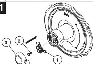
Fixez le bouton de réglage de température (1) avec la vis (2) et, en poussant fermement sur celui-ci, calez le couvercle (3) sur le bouton (1).
