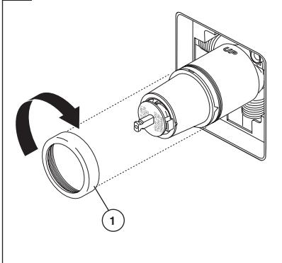
Deslice la tuerca tapa (1) sobre el cartucho y enrosque en el cuerpo de la válvula. Apriete a mano bien. .
