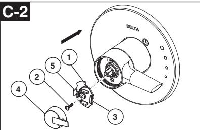
Fije la perilla para el control de la temperatura (1) con un tornillo (2) .Gancho (3) delantero coloque la perilla para el control de couverture (4) encima de perilla (1) antes de la participación parte trasera instantánea (5).
