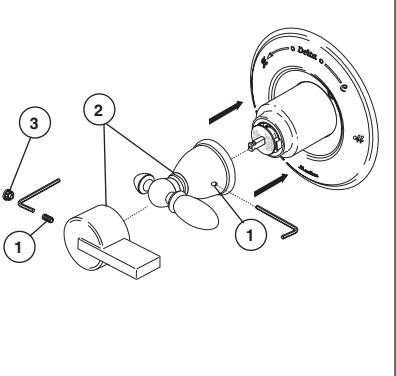
Montez la manette (2) sur la tige et bloquez-la en place en serrant la vis de calage (1) avec une clé Allen. Insérez le bouchon (3) (si votre modèle a un) dans le trou de la vis de réglage.
