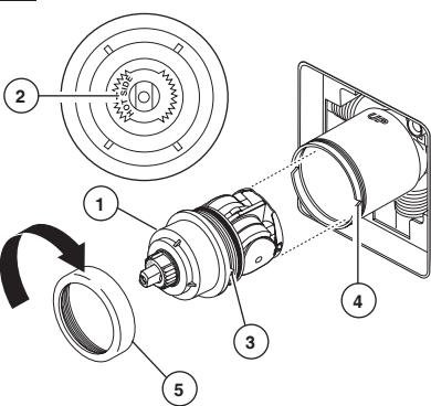
Tournez la cartouche (1) de sorte que la mention « HOT SIDE » (2) se trouve du côté gauche. Introduisez la cartouche dans le corps de la soupape. Assurez-vous que l'ergot (3) sur la cartouche est parfaitement engagé dans la rainure du corps en laiton (4). Faites glisser l'écrou à portée sphérique (5) sur la cartouche et vissez-le sur le corps. Serrez à la main fermement.
