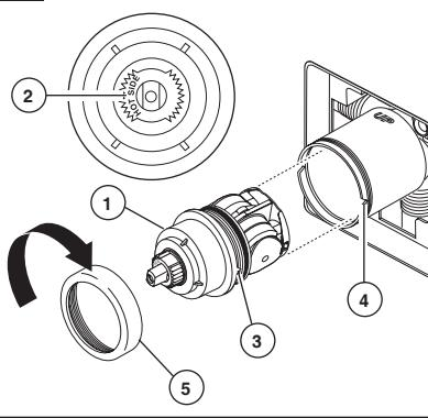
Gire el cartucho (1) de manera que las palabras 'HOT SIDE' (LADO CALIENTE) (2) aparezcan en la izquierda. Introduzca el cartucho en la válvula. Asegúrese que la guía (3) en el cartucho esté totalmente encajada en la muesca del cuerpo de latón (4). Deslice la tuerca tapa (5) sobre el cartucho y enrosque en el cuerpo de la válvula. Apriete a mano bien.
