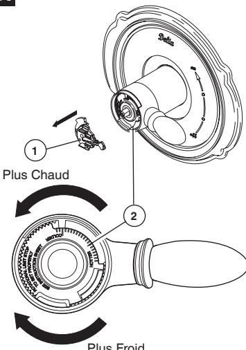
Si la température de l'eau sur le thermomètre est supérieure à 120 °F, retirez le bouton de réglage de température (1) et tournez la butée anti-échaudage (2) dans le sens horaire d'un cran par tranche de température d'environ 4 à 6 °F. Si l'eau n'est plus assez chaude, tournez la butée anti-échaudage dans le sens antihoraire.
