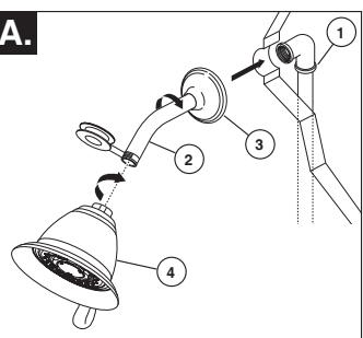
**PARA LAS INSTALACIONES DE LAS CABEZAS DE REGADERA:** Conecte la toma de salida de agua superior (1) al brazo de la regadera (2) con los accesorios apropiados. Para prevenir daño al acabado del brazo de la regadera, introduzca el extremo que va hacia la pared del brazo de la regadera dentro del reborde (3) antes de atornillar el brazo en la conexión de la tubería vertical. Aplique cinta para plomería a los enrosques a de la tubería. No apriete demasiado la cabeza de la regadera.
