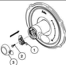
Fije la perilla para el control de la temperatura (1) con un tornillo (2) coloque la perilla para el control de cubierta (3) encima de perilla(1).
