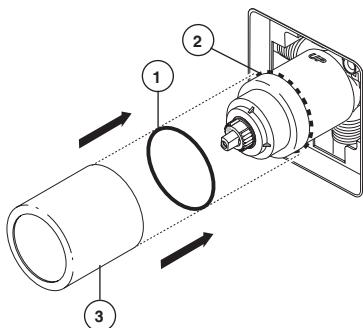
Deslice el aro O (1) sobre el cartucho y la tuerca tapa (2). El aro O, el cual funciona como un separador para estabilizar la manga, debe quedar apoyado en la tuerca tapa. Deslice la manga (3) sobre el cartucho, el cuerpo de la pieza y el aro O.
