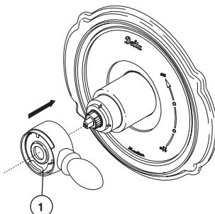
Instale la manija de control del volumen (1) con la palanca hacia la derecha, luego gírela a la posición abierta. NO FIJE CON TORNILLO.
