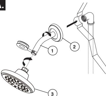
**INSTALACIÓN DE LA REGADERA / DUCHA:** Aplique cinta para plomero a las roscas en ambos extremos del brazo de la regadera (1). Para prevenir daño al acabado del brazo de la regadera, inserte el extremo de la pared del brazo de la regadera en la brida de ésta (2) antes de enroscar el brazo en la conexión a la tubería interior.
