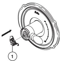
Instalación y Ajuste del Tope que Limita la Rotación
