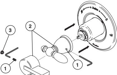
una llave Allen para fijar el tornillo de ajuste (1). Insertar el botón obturador (3) (si su modelo tiene uno) en el agujero de tornillo de ajuste.
