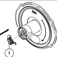
Placez le bouton de réglage de température (1) sur la manette de réglage de débit et tournez-le jusqu'à la position de mélange (au besoin). NE LE FIXEZ PAS AVEC LA VIS. Rétablissez l'alimentation en eau. Laissez couler l'eau jusqu'à ce que l'eau froide soit aussi froide que possible et que l'eau chaude soit aussi chaude que possible. Mettez un thermomètre dans un gobelet en plastique, puis placez le gobelet sous le jet d'eau et attendez un peu. Notez la température de l'eau.
