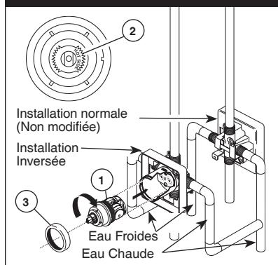
Dans le cas d'une installation dos à dos ou inversée (eau chaude à droite et eau froide à gauche) : Tournez la cartouche (1) de sorte que la mention « HOT SIDE » (2) se trouve du côté droit. Installez la cartouche en vous assurant que l'ergot est parfaitement engagé dans la rainure du corps en laiton. Faites glisser l'écrou à portée sphérique (3) sur la cartouche et vissez-le sur le corps. Serrez à la main fermement.
