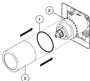
Faites glisser le joint torique (1) sur la cartouche et l'écrou à portée sphérique (2). Le joint sert de pièce d'espacement et il stabilise le manchon; il doit se trouver derrière l'écrou à portée sphérique. Faites glisser le manchon (3) sur la cartouche, le corps et le joint torique.
