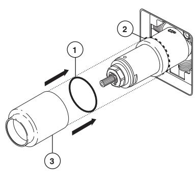
Faites glisser le joint torique (1) sur la cartouche et l'écrou à portée sphérique (2). Le joint sert de pièce d'espacement et il stabilise le manchon; il doit se trouver derrière l'écrou à portée sphérique. Faites glisser le manchon (3) sur la cartouche, le corps et le joint torique.
