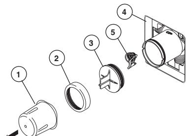
**Interrompez l'arrivée d'eau.** Enlevez le couvercle (1), l'écrou à portée sphérique (2) et le capuchon d'essai (3) du corps.
