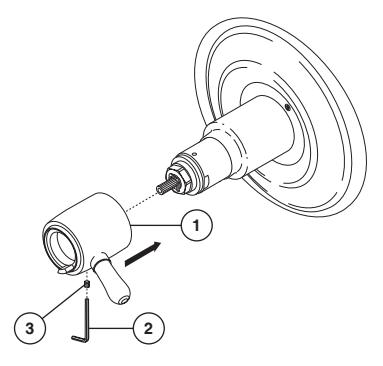
Instale la manija de control de v con la palanca a la derecha, usando una llave Allen (2) de asegurar con el tornillo de presión (3).
