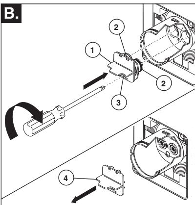
Introduisez l'adaptateur (1) dans le corps de la soupape. Assurez-vous que les joints toriques (2) sont positionnés correctement dans les trous à la base du corps. Fixez l'adaptateur avec la vis (3) se trouvant dans celui-ci. Retirez la pièce de retenue (4) de l'adaptateur.
