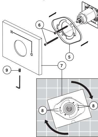
Fixez la rosace (1) et la plaque arrière (2) (si le modèle que vous installez encombre une) sur le support (3) à l'aide des 2 vis fournies (4). Prenez garde de serrer les vis de la rosace excessivement. **Si vous installez Cassidy Modèles T17097, T17297 & T17497:** Enfilez le couvercle (5) sur l'écusson (1).
