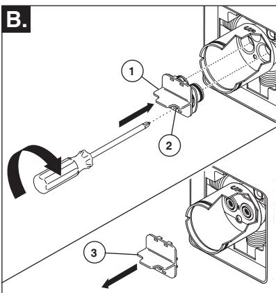
Introduzca el adaptador (1) en la válvula. Asegúrese que el adaptador estén correctamente colocados dentro de los orificios en la base de la válvula. Fije el adaptador con el tornillo (2) suministrado con el adaptador. Quite el retenedor (3) del adaptador.
