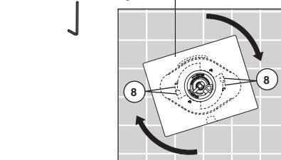
Fije la roseta con orificio (1) y la placa de atrás (2) (si su modelo tiene una) al soporte (3) usando los 2 tornillos suministrados (4). No apriete demasiado los tornillos de la roseta.
