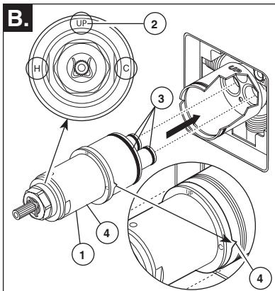
Gire el cartucho (1) de manera que la palabra "UP" (2) aparezca en la parte superior. La "H" debe estar en el lado caliente y la "C" debe estar en el lado frío. Agregue lubricante de silicona a las tres juntas tóricas (3) como se muestra más arriba para facilitar la instalación y la retirada del cartucho del cuerpo de la válvula. Inserte el cartucho en el cuerpo de la válvula como se muestra. Asegúrese que las llaves en el cuerpo están totalmente engranadas en las ranuras en el cuerpo (4).
