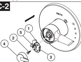
Fixez le bouton de réglage de température (1) avec la vis (2) et, accrocher avant ou poussant fermement sur calez le couvercle (3) sur bouton avant de engageant arrière bouton (1).
