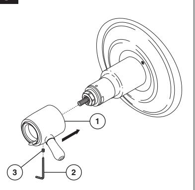
Installez la poignée de commande de volume (1) avec le levier vers la droite, utilisant une clé Allen (2) de fixer avec la vis de réglage (3).
