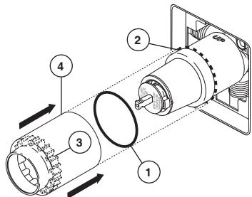
Deslice el aro O (1) sobre el cartucho y la tuerca tapa (2). El aro O, el cual funciona como un separador para estabilizar la manga, debe quedar apoyado en la tuerca tapa.
